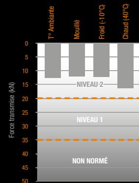
Test protection Xergo norme EN1621-1
